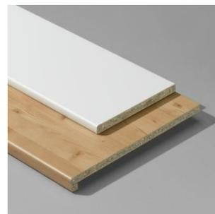
EGGER Fensterbänke sind Verbundelemente, bestehend aus EUROSPAN Rohspanplatten E1, welche mit dekorativen EGGER Schichtstoff Flex in der Fläche nahtlos beschichtet werden. Zum Schutz vor Feuchtigkeit ist die hintere Längskante der Fensterbank mit einer Melaminkante beschichtet.
