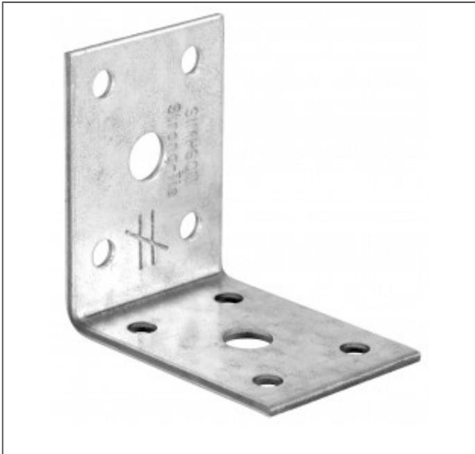
Die Winkelverbinder werden für Holz / Holz oder Holz / Beton Anschlüsse in konstruktiven Bereichen eingesetzt. Für eine gleichmäßige Lasteinleitung werden zwei Winkel je Anschluss empfohlen.
