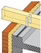
Die Profilanker wurden zur Aufnahme von Zugkräften entwickelt und werden gegenüberliegend angeordnet.
