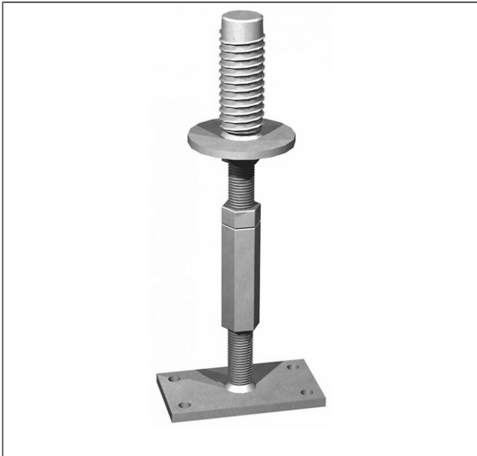
Diese Stützenfüße bestehen aus einem Kopfteil mit Spezialgewinde, das eine einfache Montage und hohe Auszugswerte gewährleistet. Der Typ CPB ist zum Aufdübeln und auch nach der Montage höhenverstellbar.
